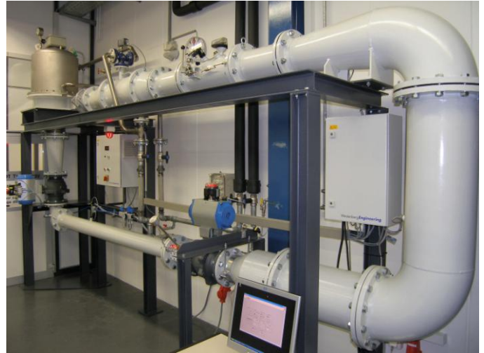
Druckluftkanal/ Pressurized calibration channel Für / for w_N up to 200 m/s
