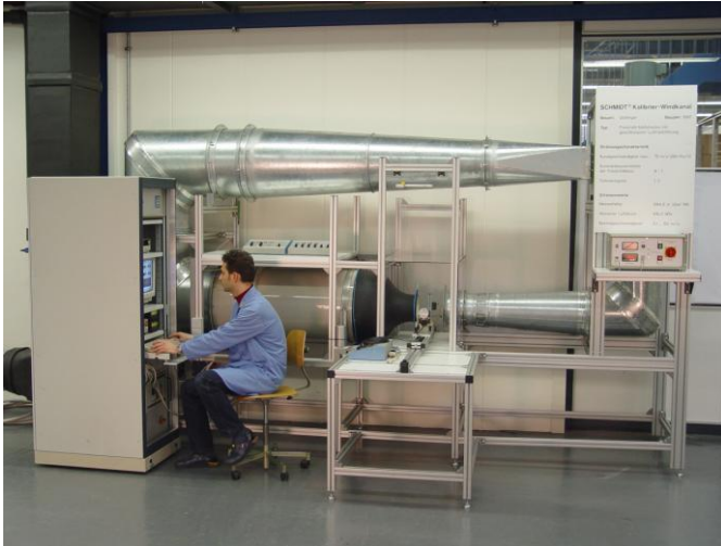
Kalibrierkanal / Calibration channel Für / for w_N up to 70 m/s
